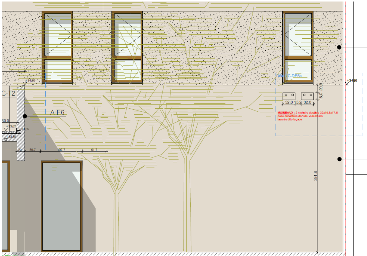
Figure 32 : Zoom sur la localisation des nichoirs double à moineau au sein de la façade nord, côté jardin de la tranche 1 - Atelier 56S
